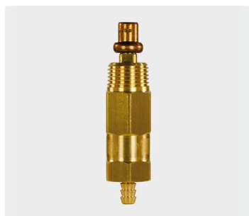
1/2" m : racor 6 mm. válvula con sonda de cobre. temperatura de funcionamiento 63 °C. máx. 10 bar
