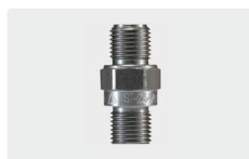
1/4" m. acero inox. ⓘ 37,8 mm. presión de funcionamiento 0,05 - 0,1 bar. máx. 400 bar / 90 °C
