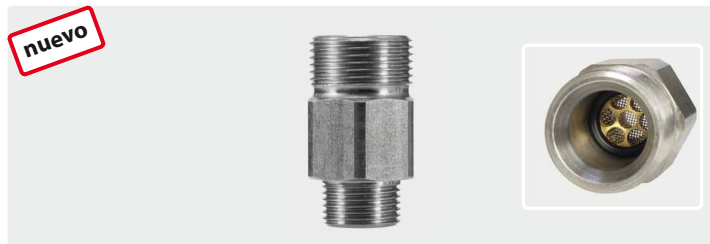
acero inox con soporte de filtro de latón. apropiado como prefiltro para inyectores ST-164. máx. 400 bar / 100 °C
