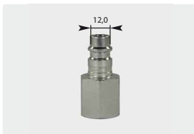
racor : rosca h. ∅ 12 mm. acero niquelado. máx. 250 bar / 100 °C
