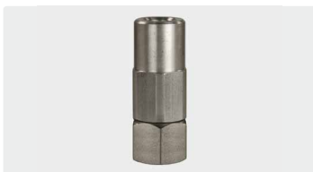
1/4" h : 3/8" h. acero inox. racor giratorio con rodamientos radiales giratorios. máx. 350 bar / 90 °C
