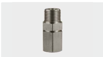
1/2" m : 1/2" h. acero inox. máx. 350 bar / 90 °C
