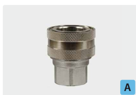
acoplador : rosca h. latón niquelado. máx. 250 bar / 150 °C
