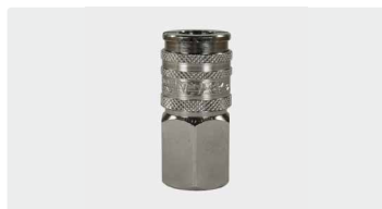
acoplador : rosca h. latón cromado / acero cromado. máx. 200 bar / 100 °C
