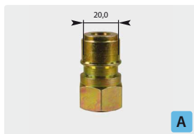
racor : rosca h. acero zincado. máx. 250 bar / 150 °C
