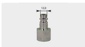
racor : rosca h. ⌀ 12 mm. acero niquelado. máx. 200 bar / 100 °C
