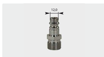
racor : rosca m. ⌀ 12 mm. acero niquelado. máx. 200 bar / 100 °C
