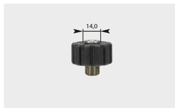
corto M22 : rosca m. acero inox. máx. 400 bar / 150 °C
