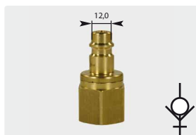
racor : rosca h. ∅ 12 mm. latón. con válvula. máx. 35 bar / 100 °C
