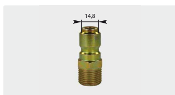
racor : rosca m. ⌀ 14,8 mm. acero zincado. máx. 150 bar / 100 °C
