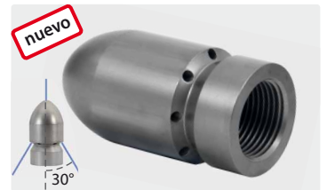
1" h. ⌀ exterior 48 mm. 8 orificios hacia atrás, con perforación
