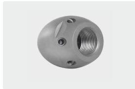
3/8" h. 6x 75° +1x 0°. 25-70 l/min. Para R \varnothing 75-150 mm. \varnothing exterior 35 mm. \boxplus 207 g.
