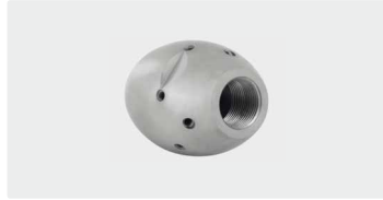
3/8" h. 6x 75° 3x 30° +1x 0°. 30-100 l/min. Para R \varnothing 100-200 mm. \varnothing exterior 35 mm. \boxplus 314 g.
