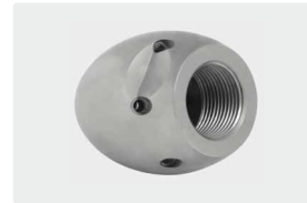
3/4" h. 6x 75° +1x 0°. 30-100 l/min. Para R \varnothing 120-250 mm. exterior \varnothing 50 mm. \boxplus 567 g.
