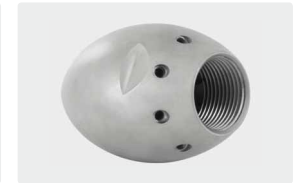
1" h. 8x 75° +1x 0°. 100-250 l/min. Para R \varnothing 150-300 mm. \varnothing exterior 62 mm. \boxplus 1.265 g.
