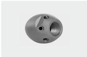
1/4" h. 6x 75° +1x 0°. 20-50 l/min. Para R \varnothing 50-100 mm. \varnothing exterior 30 mm. \boxplus 127 g.
