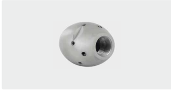
1/4" h. 6x 75° 3x 30° +1x 0°. 25-70 l/min. Para R \varnothing 75-150 mm. \varnothing exterior 30 mm. \boxplus 223 g.
