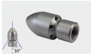
1/4" h. ⌀ exterior 25 mm. 6 orificios hacia atrás, con perforación
