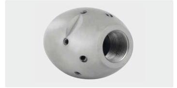
3/4" h. 6x 75° 3x 30° +1x 0°. 100-250 l/min. Para R \varnothing 150-300 mm. \varnothing exterior 50 mm. \boxplus 1.367 g.
