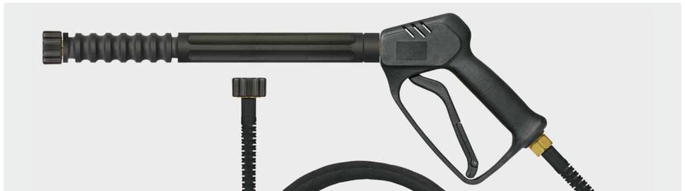
pistola con extensión 340 mm, máx. 210 bar / 25 l/min / 150 °C. entrada / salida M22 h.
