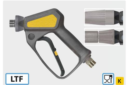
pistola profesionales con la tecnología patentada de LTF. acero inox. bola de cerámica, valvula resistente a los productos quimicos y kit de juntas resistente a los ácidos acero inox. pistola para aplicaciones industriales con medios agresivos. máx. 350 bar / 45 l/min / 150 °C
