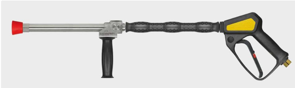
3/8" h. acero inox. lanza de largo alcance 350 mm con protección rejilla ST-29 Cool & Compact 330 mm, pistola ST-2300, puño latera y protección para tobera plástico sin tobera. máx. 280 bar / 45 l/min / 100 °C
