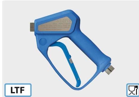
pistola profesionales con la tecnología patentada de LTF. acero inox. bola de cerámica, valvula resistente a los productos quimicos y kit de juntas resistente a los ácidos acero inox. pistola para aplicaciones industriales con medios agresivos. máx. 350 bar / 45 l/min / 150 °C
