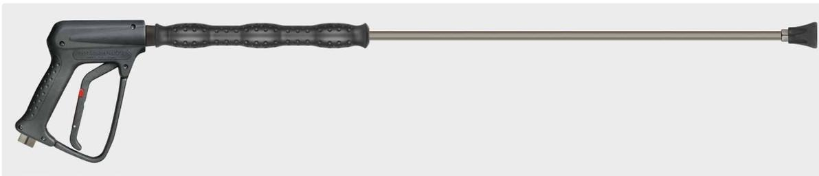
pistola profesionales R+M EcoLine No. ONE con lanza 900 mm acero zincado, aislamiento ST-28 Cool & Compact 300 mm y protección para tobera ST-10 sin tobera. máx. 250 bar / 45 l/min / 150 °C
