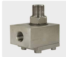
1/4" h : 3/8" m. carcasa y eje acero inox. máx. 600 bar / 90 °C
