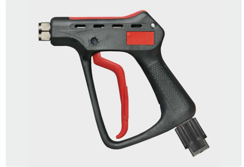
pistola profesionales de altísima presión. máx. 600 bar / 80 l/min / 150 °C
