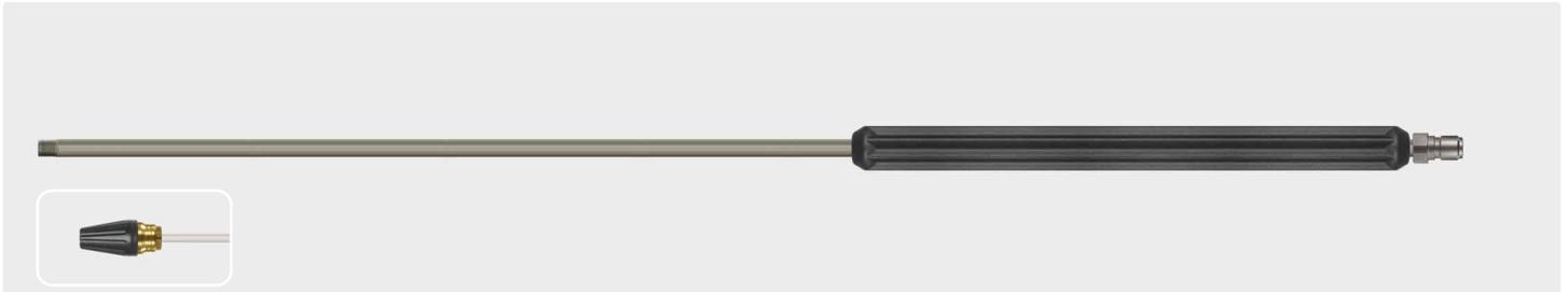
acoplamiento ST-3100. lanza acero inox, aislamiento 400 mm y conexión 1/4" m para toberas rotativas. lanza sin tobera rotativa. máx. 400 bar / 150 °C
