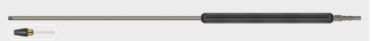
acoplamiento KW. lanza acero inox, aislamiento 400 mm y conexión 1/4" m para toberas rotativas. lanza sin tobera rotativa. máx. 400 bar / 150 °C
