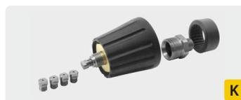
limitador de flujo para reducir la cantidad de agua. con adaptador y boquillas dosificadoras (1.0, 1.1, 1.2, 1.3, 1.4)
