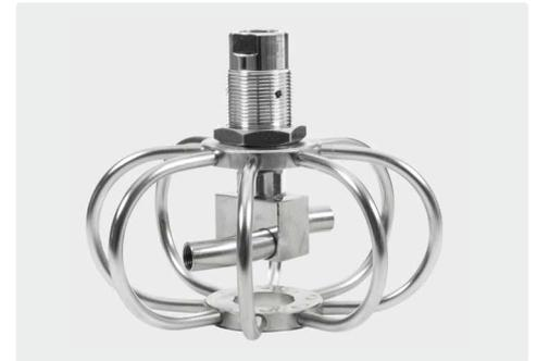
TYR-2f fijo. limpiador de conductos con los brazos rectos, rotor para un ángulo de pulverización horizontal. ideal para la limpieza de conductos verticales. completamente libre de óxido. entrada 3/8 "h. boquillas no están incluidas. 2 boquillas de 1/8" m se requieren. máx. 275 bar / 120 °C
