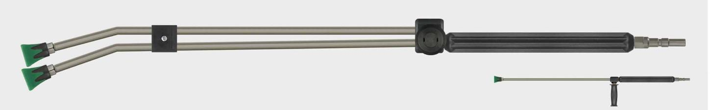
acoplamiento KW. lanza acero inox, aislamiento 300 mm, válvula lateral ST-54 y protección para tobera ST-10 con tobera de baja presión & porta tobera 1/4" h. máx. 310 bar / 150 °C
