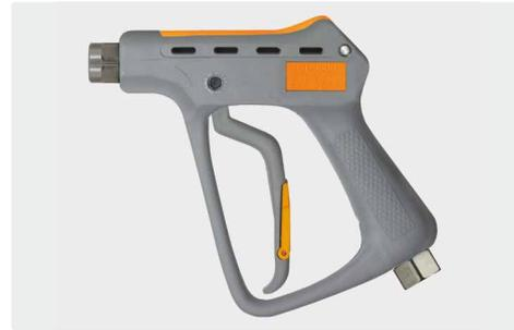
pistola profesionales alto flujo. acero inox. pistola industrial especial para ayuntamientos y otros sistemas de limpieza. cierre de la válvula de acero inoxidable templado. máx. 350 bar / 200 l/min / 150 °C
