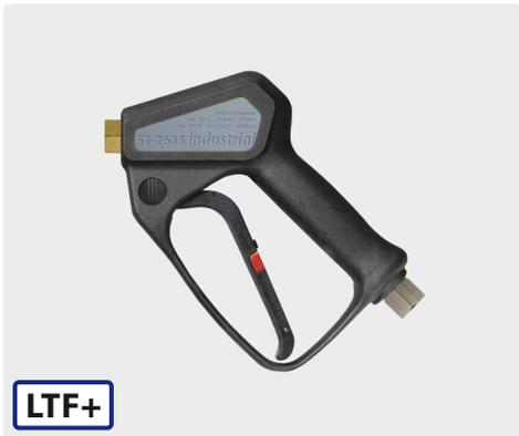
pistola profesionales. conjuntos de válvula patentadas. bolas resistente al desgaste de carburo. completo giratorio acero inox. máx. 400 bar / 35 l/min / 150 °C
